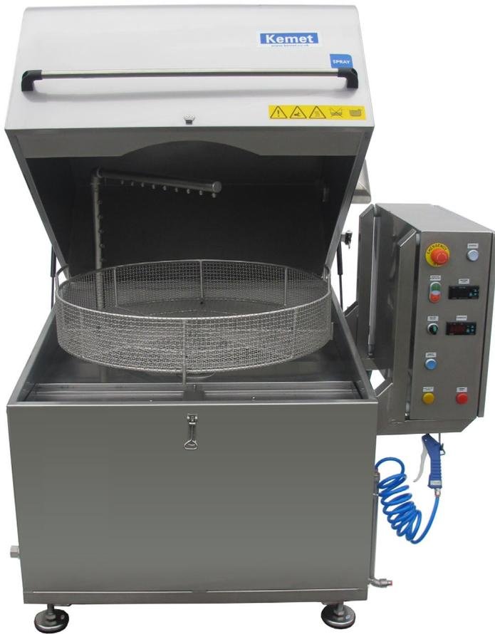
Podemos ofrecer lavadoras de pulverización de carga superior y etapa única. A menudo es necesario limpiar las piezas antes del mantenimiento o entre las fases de producción, no solo por razones técnicas, sino también para la comodidad del operador. La lavadora Spintec es la solución ideal para limpiar piezas rápidamente y en una cámara cerrada para un mejor ambiente de trabajo.
