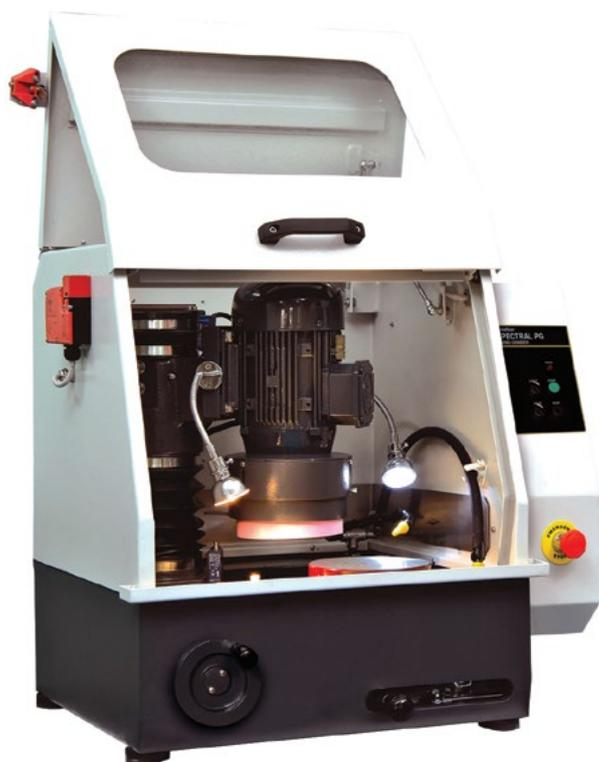
用于光谱分析的钢铁样品快速，湿法或干磨的台式摆锤磨床。还可以通过使用特殊的杯形砂轮在光谱 Spectral - PG上制备其他材料。
