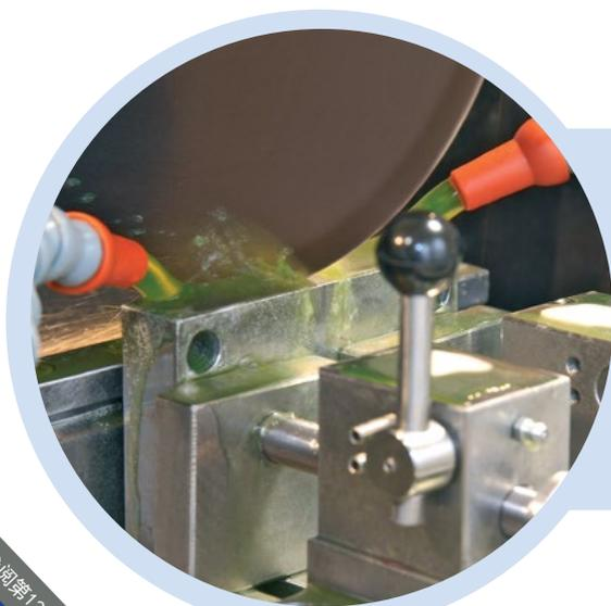
许多样品制备来至小或不规则形状样品或组分的样品的切片，因此可能产生定位和夹持困难。为了克服这些问题，Kemet拥有许多特殊的夹紧装置，全部由不锈钢制成，可以在几秒钟内连接到T型槽床上，实现任何配置的紧固和正夹紧。
