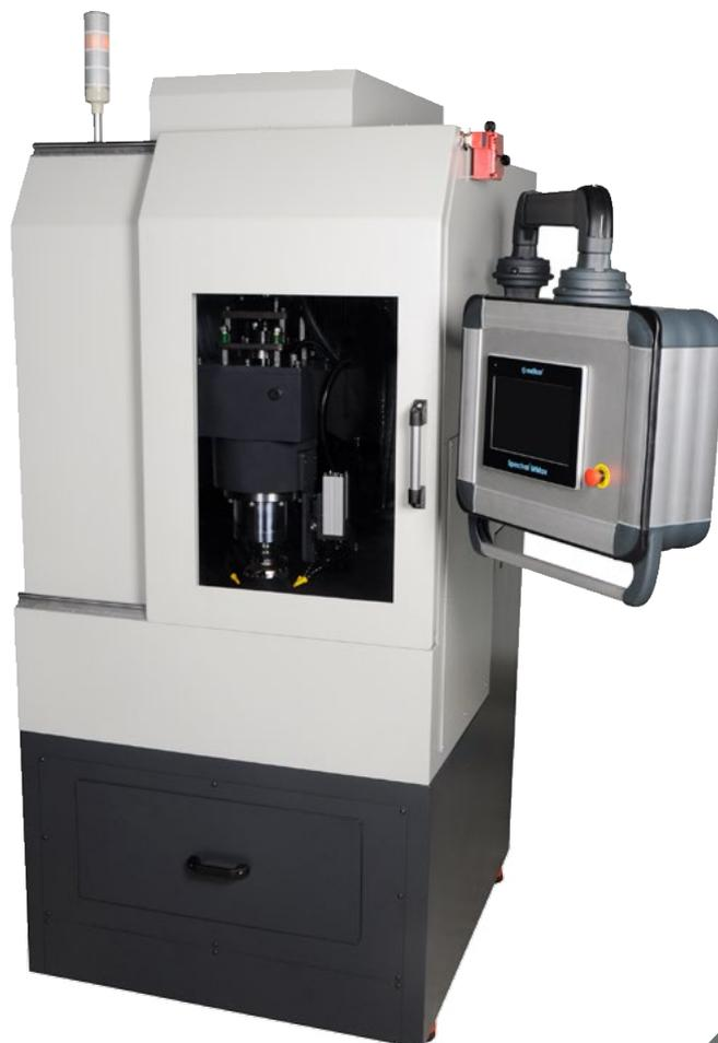
Spectral- Mmax是一种全自动铣削机器，用于钢，铸铁和有色金属样品表面的快速，精细铣削，同时也用于光学发射和X射线光谱仪分析，给操作者提供最高水平的样品重复性处理。
