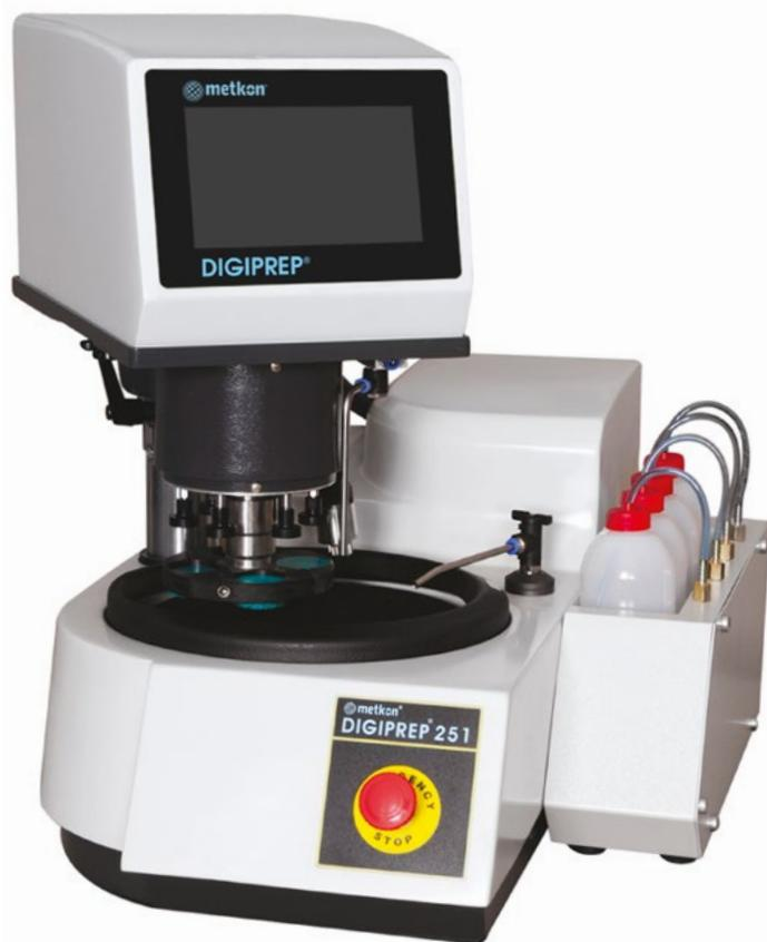
Digiprep 251/301制备系统设计用于全自动金相样品制备，提供始终如一的高质量样本。Digiprep的自动头精确控制施加的压力度，确保标本每次准备完全相同，独立于操作员技能。Digiprep 251和301由高扭矩1.0 HP电动机驱动，提供从50到600 rpm的平滑速度变化，软启动和软停止
