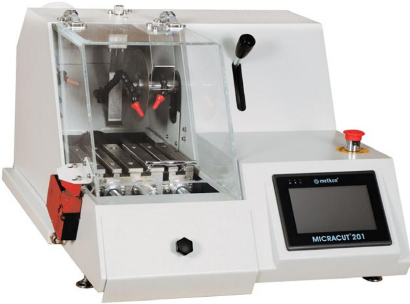
Miracut系列机器的设计在切割操作时减少结构变形，并保持样品的结构完整性，从而对切割表面进行微观检查，为金相试样做准备，减低抛光。
