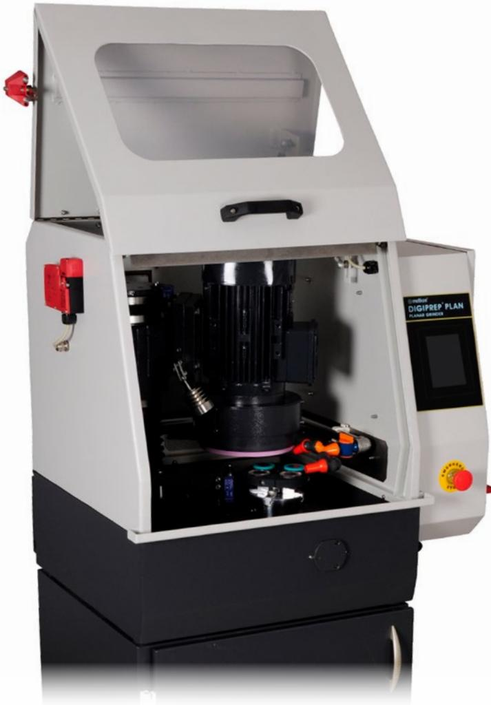
平面粗磨机设计用于大型样品的第一步初始平面磨削，或样品夹具中的大量样品。提供高质量的平面样品表面快速磨削，节省了后续精细研磨和抛光步骤的时间。
