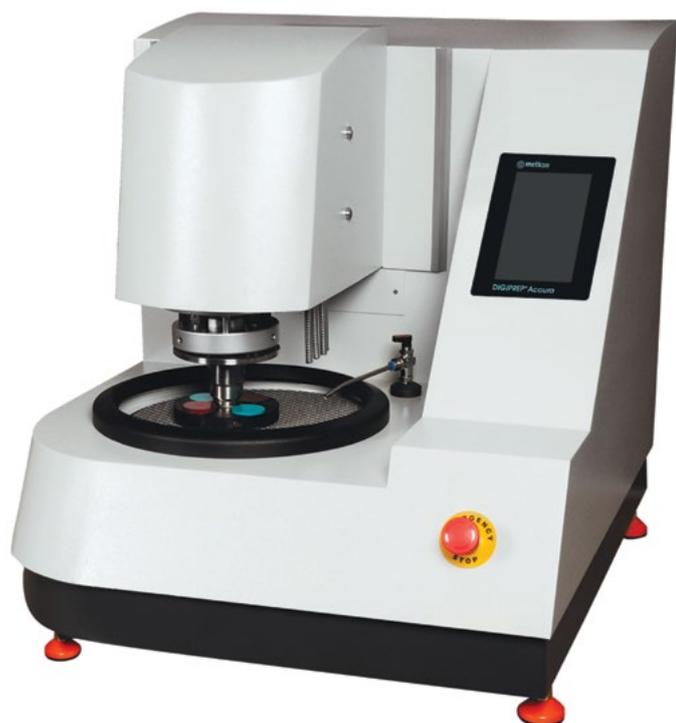
Digiprep Accura适用于对试样表面平面度高需求
