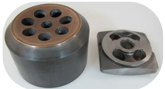
Faites correspondre le corps de la pompe à piston rodé de 125 mm et le plateau cyclique
