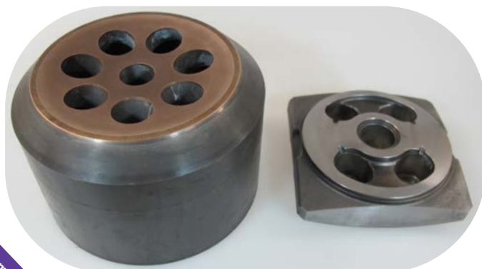
Gleichläufig geläppter 125mm Kolbenpumpenkörper und Schwungscheibe
