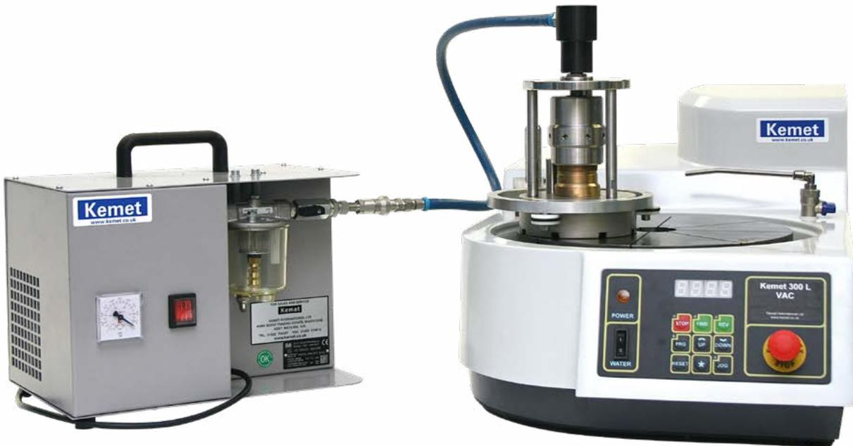
La máquina básica tiene un plato de diámetro 300 mm. Todos los elementos de accionamiento están montados sobre un estativo de fundición de aluminio de alta resistencia, ofreciendo una operación sin vibraciones y un funcionamiento silencioso. La entrada de agua y su válvula de control son elementos de serie.
